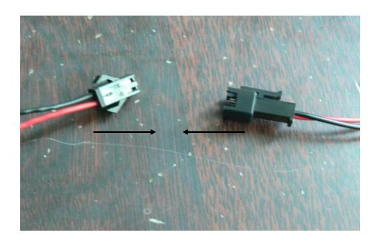
Connect these connectors to transfer the power from the back to the seat (Nối hai dây điện này lại để chuyển điện của vibration từ phần dựa (back) đến phần ngồi (seat))
