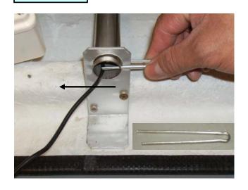
Lock the metal pole using the pin as shown in picture. (Khóa ống in-nox lai bằng cái pin như trong hình)
