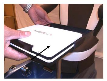
Install the DVD player by sliding it into the tray. Make sure the audio control is in the open cut in the tray. (Gắn máy DVD vào khay nhựa bằng cách chuồi vào. Chú ý phía volume control là phía có lỗ cắt ở khay nhựa)
