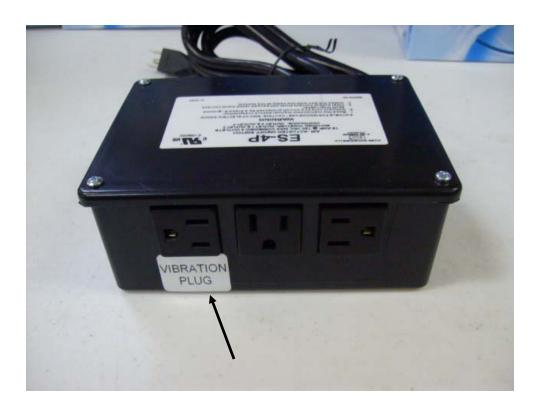
Plug the vibration power adapter to the outlet as labeled on the black box (Cám adapter của vibration vào ổ cám đã được label sẵn như trên)
