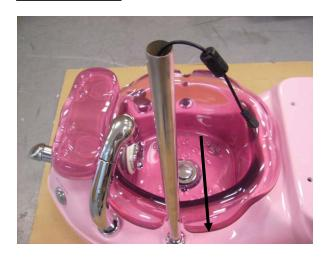
Insert the metal pole into the holders. (Cắm ống in-nox vào lỗ như trong hình bên)
